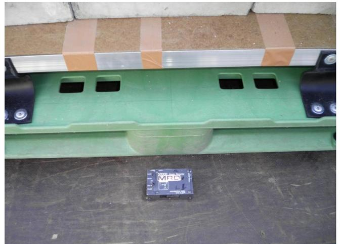
G計測器取付け図 ② (振源)
